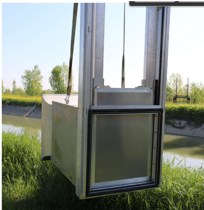
Figura 2: Dettaglio della paratoia, con visione della guarnizione di tenuta e dello scudo
